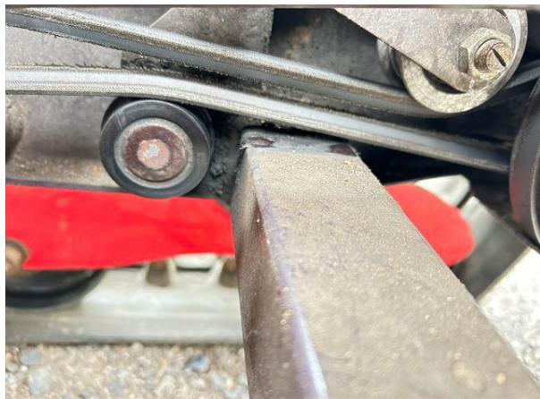
駆動ベルトをプーリーに乗せても駆動すると外れる
