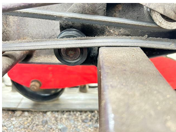
駆動ベルトの通常状態、フレームに接触している
