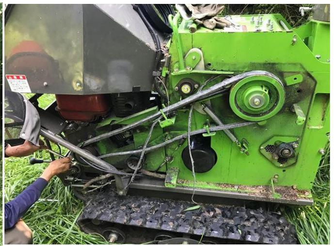
作業開始前に断裂したローターベルトの交換
