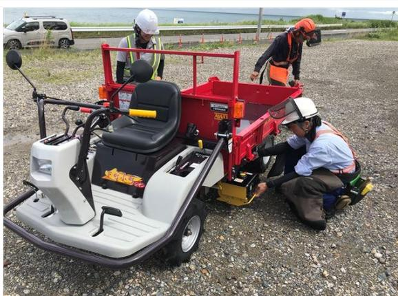
4輪ダンプの外観 積載重量は600kg
