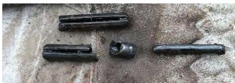
2021/03/13にピンが割れて、交換したときのスプリングピンの構造
