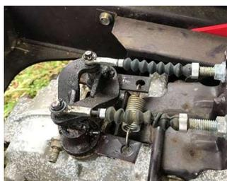
左右のアームを繋ぐスプリングを取り付けて、クラッチワイヤーの遊びを調整する
