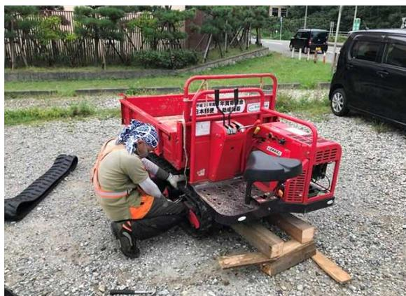
交換作業開始、角柱で車体を浮かして交換
