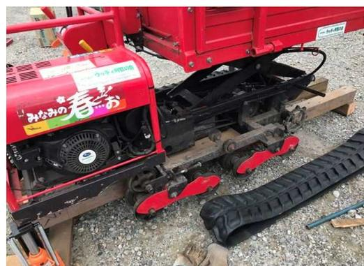
交換前のクローラ。右端駆動スプロケットで前進方向
