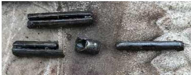
上が右側クラッチの無傷のピン、下が割れていた左側クラッチの外側ピンと内側ピン
