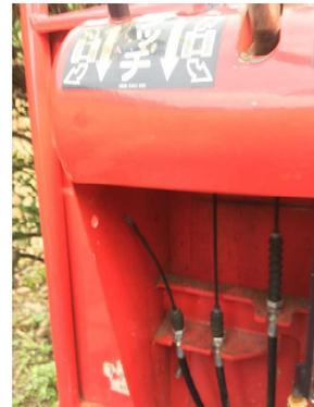
コントロールパネル下断線した左側クラッチワイヤー
