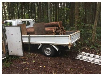
運搬車の荷台をリフトする際、高さを稼ぐためにアルミラダーで下駄を履かせた。
