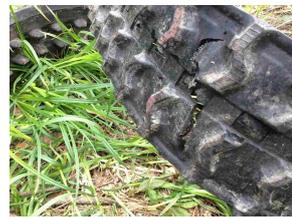
←裂けた右側のゴムクローラ、内部のスチールコードが断裂してた
