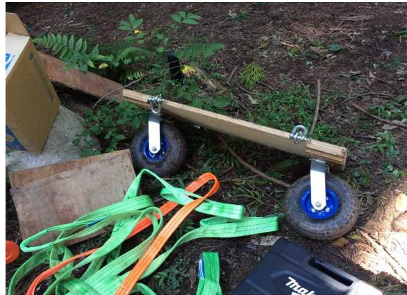
横向きの力に耐えきれず車軸破損
