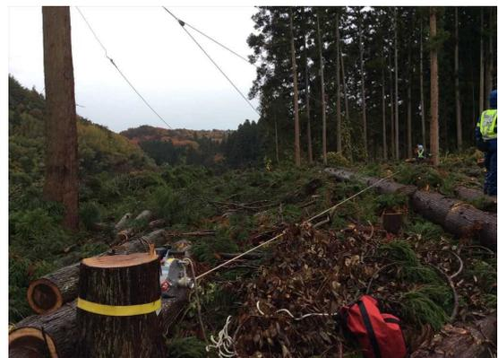
動滑車で倍力に、チルホールで向かい風による倒れ止め
