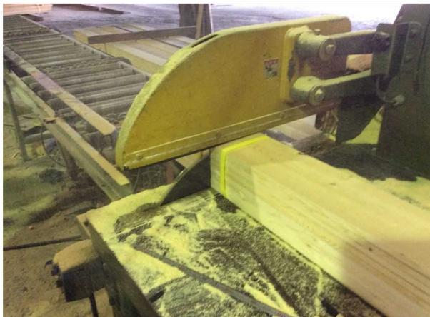
刃のアサリ幅は2.5mm程度、大きな刃がしたからせり上がる
