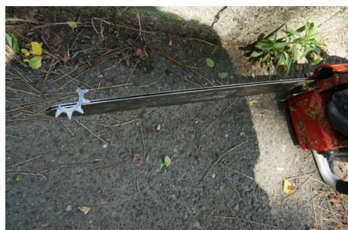
ガイドバーの先端スプロケットが破損
